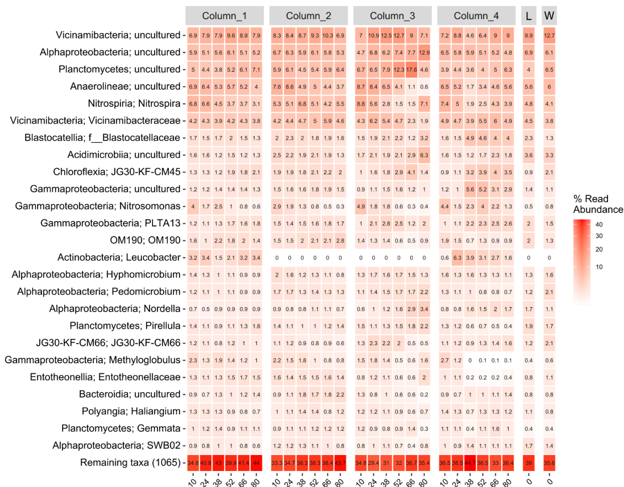
Figuur 23: Heatmap van de top 25 meest abundante genera in de kolomexperimenten. De getallen in de cellen zijn relatieve abundanties (%), op de x-as staan de monsterdagen. De experimentele opzet van de verschillende kolommen (column 1-column 4) staat in Tabel 4. Kolom 1: 10% RSF-entmateriaal, nutriënten en sporenelementen; kolom 2: 10% RSF-entmateriaal en sporenelementen; kolom 3: 10% RSF-entmateriaal en nutriënten; kolom 4: nutriënten en sporenelementen.
