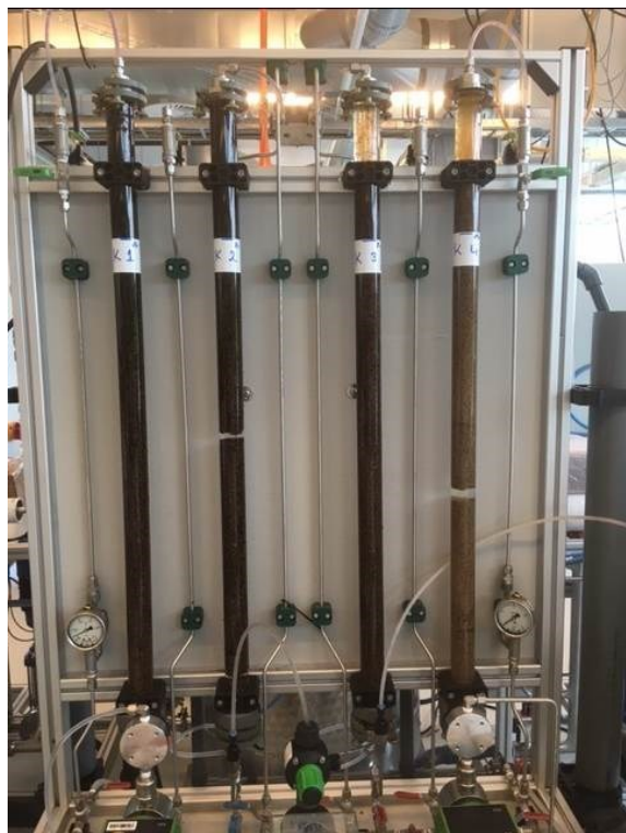
Figuur 8 Foto van de kolommen tijdens een spoeling, waarbij vaak breuken in het bed ontstonden.
